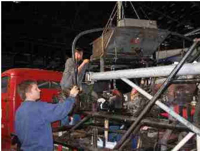
Zerlegen der „alten Winde“ in alle Einzelteile. Rodolfo Becker (oben) dirigiert die Entfernung des Windenfahrerstand vom alten Fahrgestell.
